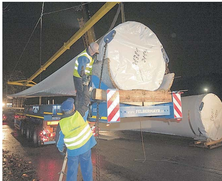
Ein Autokran hievt das Rotorblatt auf den Spezialtransporter.
